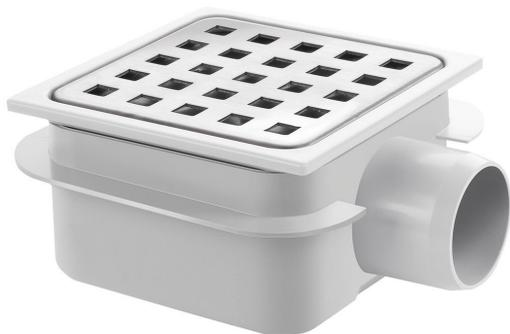
Corpo in ABS. Griglia in acciaio inox AISI 304 con fori larghezza 8 mm. Bordo e griglia regolabile in altezza. Con bordo stabilizzante attorno al contenitore di scarico. Scarico 20 L/min.
